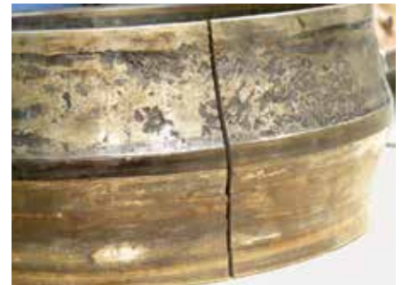
Bague intérieure d'un roulement à rotule sur rouleaux de contrefaçon.
